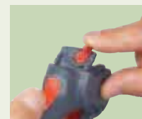
2 Querschnitt wählen mit Justierhebel
