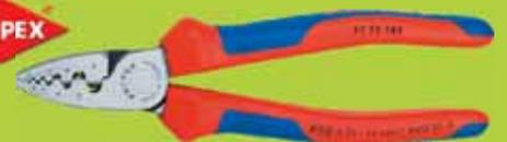
Kopf poliert, Griffe mit Mehrkomponenten-Hüllen. **Anzahl der Nester 9 Stück.** Zum Verpressen von Aderendhülsen nach DIN 46228 Teil 1 + 4 im Bereich von 0,25 bis 16 mm<sup>2</sup>. Verpressung in gekennzeichneten Halbbrundprofilen für die sichere Verbindung von Hülse und Leiter. 9 besonders tiefe Profile mit konischen Seitenflächen. Spezial-Werkzeugstahl, geschmiedet, ölgehärtet.
