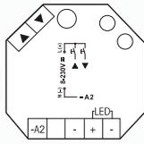
**Power MOSFET für LED-Lampen 12-36V DC bis 4 A, Pulsweiten-Modulation PWM. Stand-by-Verlust nur 0,1 Watt. Mindesthelligkeit oder Dimmgeschwindigkeit einstellbar. Mit Kinderzimmer- und Schlummerschaltung.**
