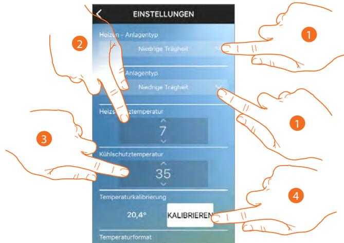
1. Wählen Sie den Wert der thermischen Trägheit (Kapazität einer Struktur, ihre eigene Temperatur mehr oder weniger langsam zu verändern) je nach Anlagentyp und die Geschwindigkeit, mit der die installierten Geräte heizen/kühlen.
